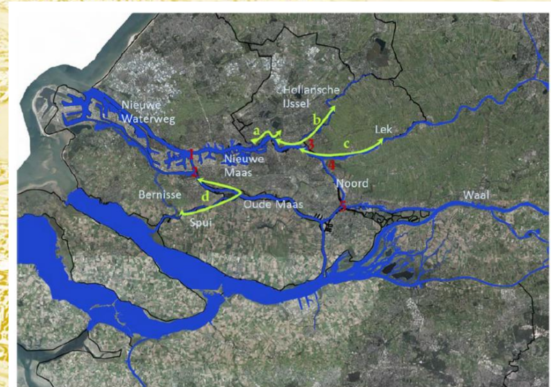
Figuur 4-5 Positionering van de incidentele meetcampagnes in de RMM. Gekoppeld aan voorgaande tabel waarin de te meten splitsingspunten met cijfers 1-5 zijn gegeven en de trajectmetingen met letter a-d.
